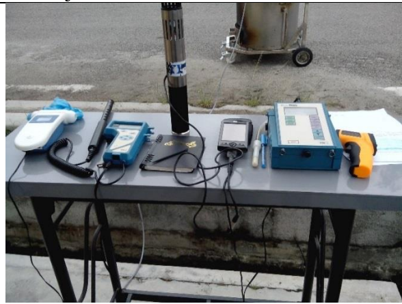
Pengukuran suhu dinding insinerator, kadar pengeluaran asap yang menepati Jabatan Alam Sekitar
