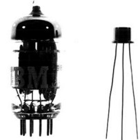
Perbandingan Saiz: Tiub Vakum vs. Transistor.
